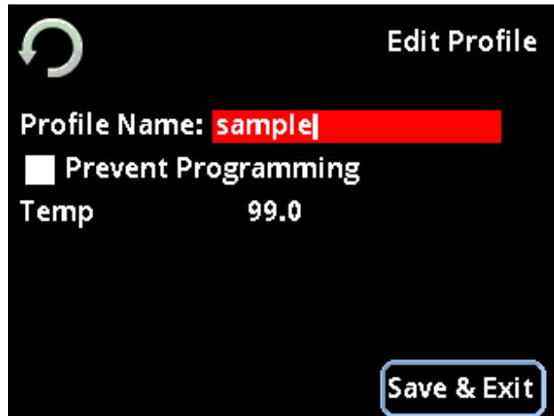
3. Impostare le temperature della zona calore se desiderato. Per modificare la temperatura impostata è sufficiente sfiorare il valore della temperatura sullo schermo. Il valore sarà evidenziato. Ruotare l'encoder a sinistra o a destra per modificare il valore con incrementi di 1 grado. Premere il joystick su o giù per modificare la temperatura con incrementi di 1/10 di grado. Premere il pulsante centrale sul joystick per salvare la modifica.
