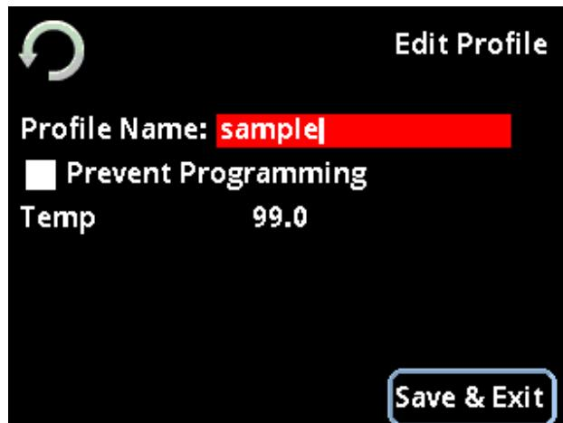
3. Régler les températures des zones chauffantes, si on le souhaite. Pour modifier la température configurée, toucher simplement la valeur de la température sur l'écran et elle sera mise en évidence. Tourner l'encodeur vers la gauche ou vers la droite pour changer la valeur par paliers de 1 degré. Appuyer sur la manette vers le haut ou vers le bas pour changer la température par paliers de 1/10 de degré. Pousser sur le bouton central sur la manette pour enregistrer le changement.
