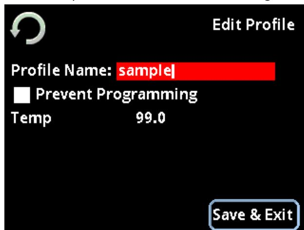
3. Nach Wunsch die Temperaturen der Heizzonen eingeben. Zur Änderung der eingestellten Temperatur muss lediglich der Wert am Bildschirm berührt werden. Der Wert wird unterlegt. Den Encoder nach links oder rechts drehen, um den Wert in Schritten von 1 Grad zu erhöhen oder zu verringern. Den Joystick nach oben oder unten drücken, um den Temperaturwert in Schritten von 1/10 Grad zu erhöhen oder zu verringern. Durch Drücken der zentralen Taste des Joysticks wird die Änderung gespeichert.
