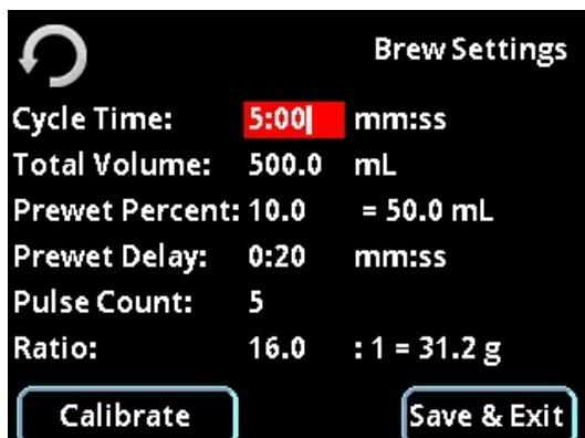
Il tempo verrà evidenziato in rosso e può essere regolato usando il joystick (+/- 10 secondi) e l'encoder rotativo (+/- 1 secondo). Premere il centro del joystick per impostare.
