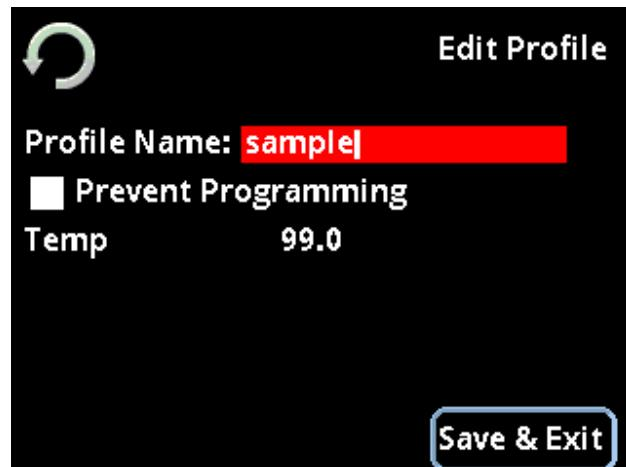
3. Fine las temperaturas de las zonas térmicas, si lo desea. Para cambiar la temperatura determinada, simplemente toque el valor de la temperatura en la pantalla; el valor se resaltará. Gire el codificador hacia la izquierda o la derecha para cambiar el valor en incrementos de 1 grado. Presione el joystick hacia arriba o abajo para cambiar la temperatura en incrementos de 1/10 grados. Presione el botón del centro del joystick para salvar el cambio.
